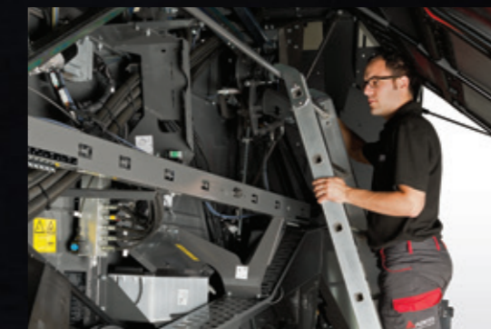
Poręcz przy drabince sprawia, że inspekcje są proste i bezpieczne
