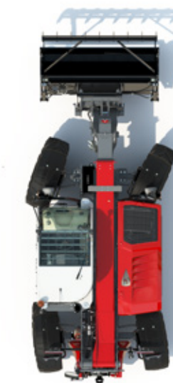
TRYB KIEROWANIA „PÓŁ-KRAB” ustawia kąt tylnego koła: przydatny w takich zastosowaniach, jak usuwanie kiszonki lub czyszczenie stodoły.
