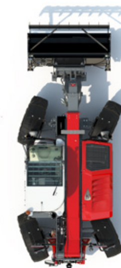
TRYB DWIE OSIE SKRĘTNE: minimalna średnica zawracania.
